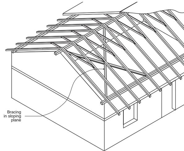
Fig. 70 : Roofing bracing
