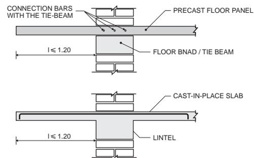
Fig. 61 : Cantilever slab
