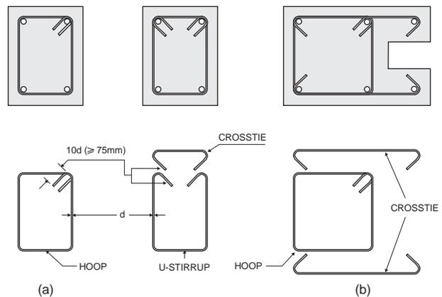
Fig. 55 : Beam web reinforcement
