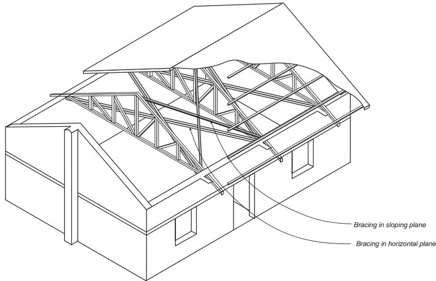
Fig. 77 : Roof bracing
